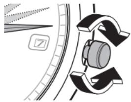
将分针从正确时间向前拨快 5 分钟后再返回到正确时间。这样可以将齿轮间隙的影响减到最小并提供更精确的指针位置。
